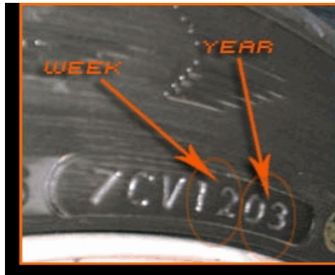
תאריך הייצור על גבי הצמיג 1203 (שבוע 12 שנת 2003)
